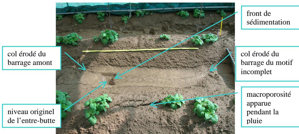
Figure 14 : barrage amont de l'entre-butte compacté de l'essai B1 après la pluie (le mètre pliant jaune mesure 1,6 m, l'aval est à gauche)
