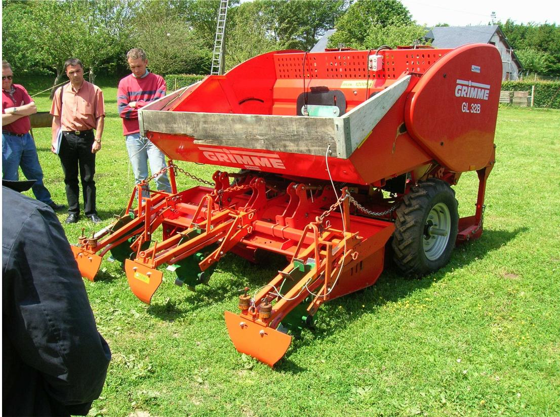
Figure 6 : la version 2006 du prototype des pelles à micro-barrages, installée sur la planteuse de l'agriculteur.
