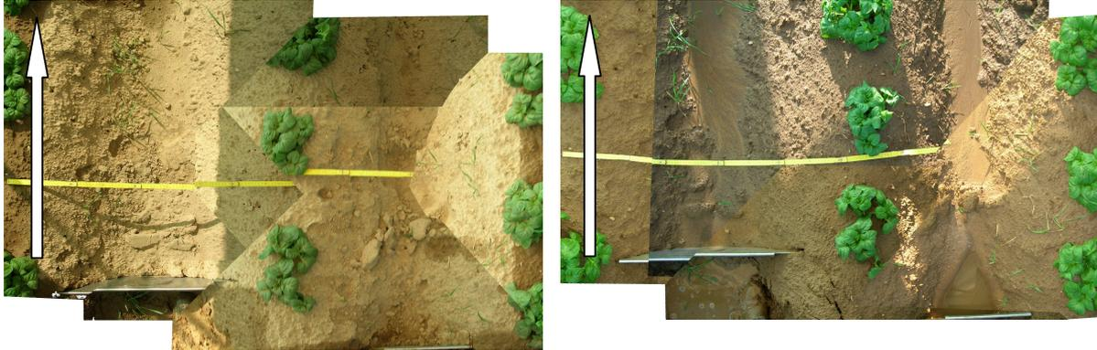
Figure 16 : modalité avec micro-barrage, essai 2, le 8 juin 2006, avant la pluie à gauche, après la pluie à droite (la flèche indique le sens de la pente)
