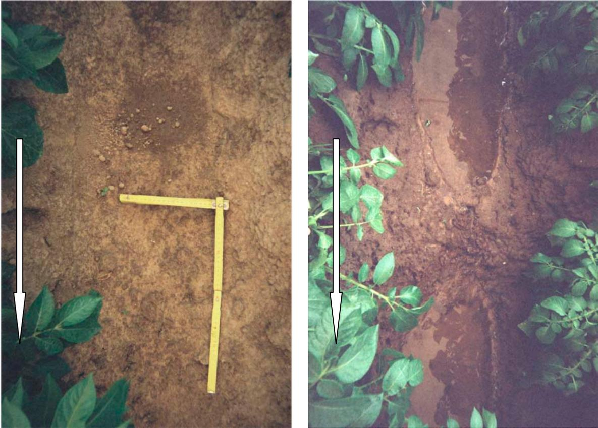
Figure 10 : modalité *micro-barrages*, essai 1, le 27 juin 2005, avant la pluie à gauche, après la pluie à droite, la flèche indique le sens de la pente
