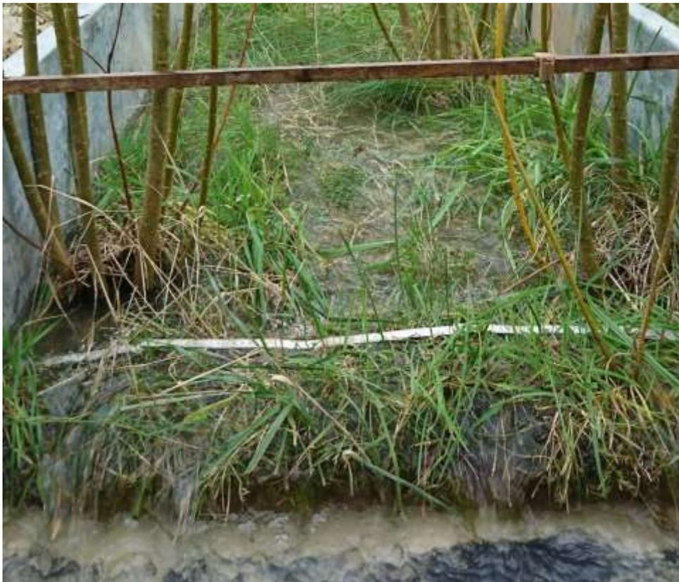
Figure 25 - Débit à 6 L/s/ml utilisé pour estimer la capacité de ralentissement dynamique sur le Saule/Herbe de Sainte Colombe
