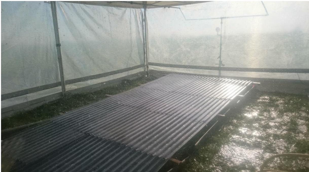
**Figure N° 5** : Exemple d'une installation pour effectuer une mesure précise de l'intensité de pluie délivrée sur la surface exacte d'une placette (GDVL 1 le 25/02/2016)
