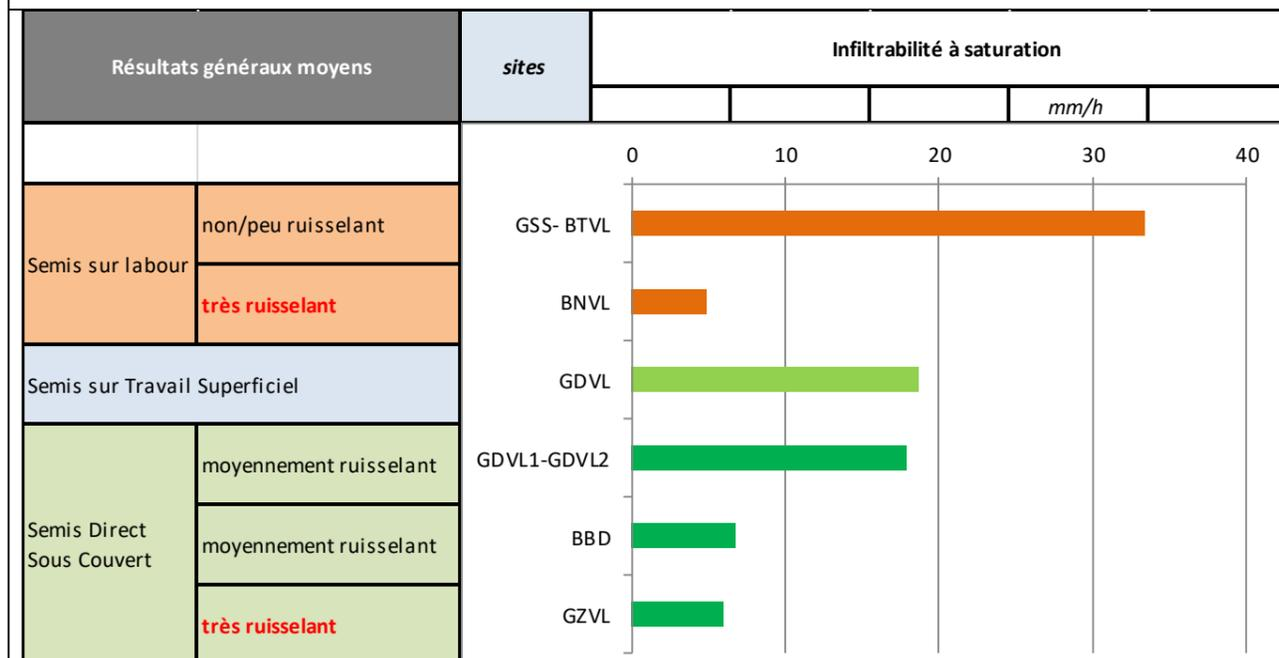
Figure N° 47 : Comparaison des infiltrabilités moyennes à saturation sous pluie simulée avec une intensité moyenne de 35 mm/h en fonction des modes d'implantation du blé
