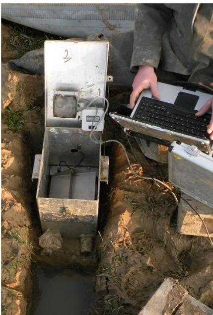
Figure N° 3 : Auget basculeur avec enregistreur et fosse de sortie en aval
