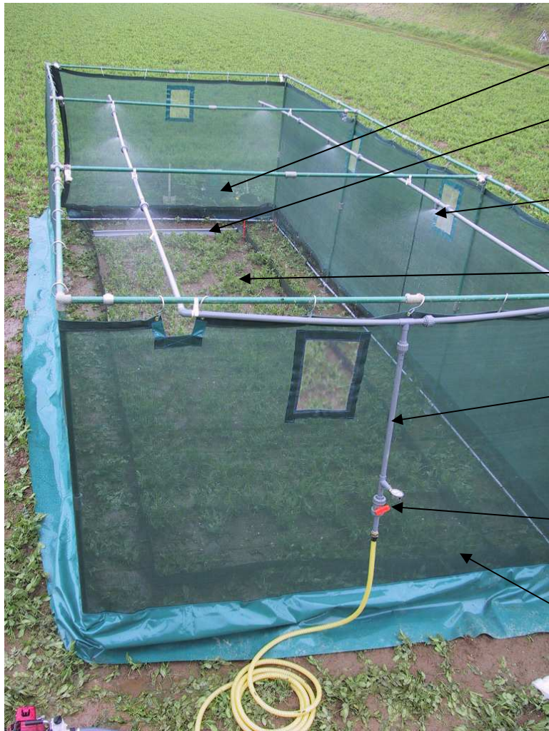
Figure 3- le simulateur de pluie de l'AREAS en fonctionnement, sans son toit.
