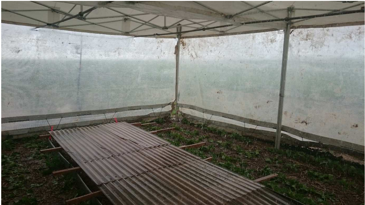
Figure 2 - Exemple d'une installation pour effectuer une mesure précise de l'intensité de pluie délivrée sur la surface exacte d'une placette
