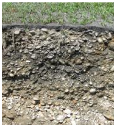
Figure 15 : a) Colmatage du fond d'un bassin d'infiltration (Programme ECOPLUIES, 2009) – b) Biofilm sur le fond d'un bassin d'infiltration
