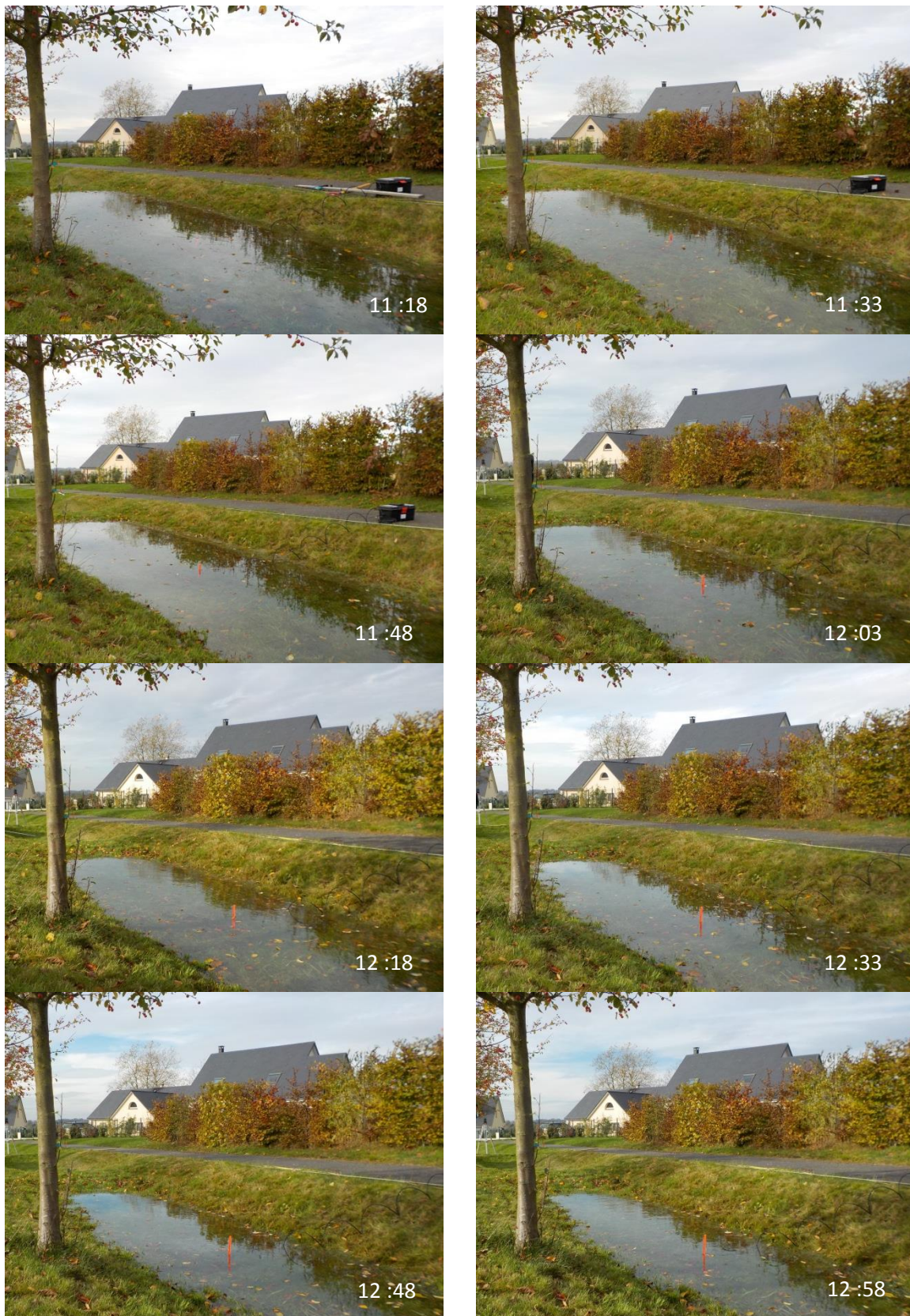
Figure 32 : Vidange d'une noue (méthode par remplissage)
