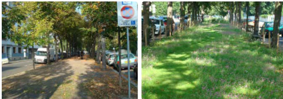
Figure 63 : Exemple de désimpermeabilisation d'une zone urbaine existante (Métropole de Starsbourg, dans Vers la ville perméable, comment désimpermeabiliser les sols, Bassin Rhône Méditerranée, mars 2017)
