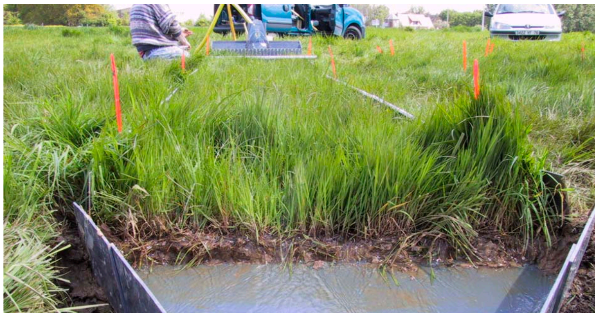
Figure 2 : vue d'ensemble de la première répétition de la modalité bout de champs enherbé tassé en cours d'expérimentation (largeur : 1 m, longueur : 6 m)
