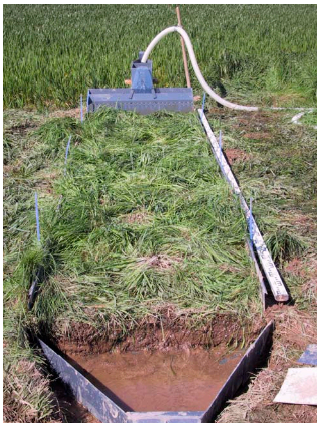
Figure 6 : vue d'ensemble de la modalité bout de champs enherbé non tasse (largeur : 1 m, longueur : 4,1 m)
