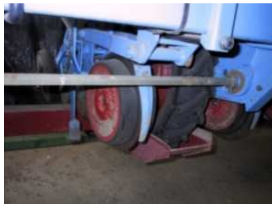
Semoir à betteraves avec les disques ouvreurs
